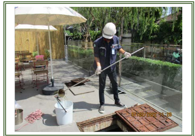
รูปที่ 3-4 การเก็บตัวอย่างคุณภาพน้ำทิ้ง บริเวณจุดระบายน้ำออกจากระบบบำบัดน้ำเสีย
